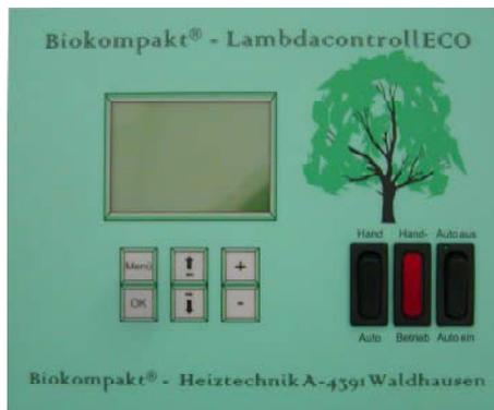
La regolazione Lambda per Pellet e cereali energetici è attrezzata con una regolazione di potenza per il campo di potenza tra il 30% al 100%. Una sintonizzazione automatica del combustibile garantisce sempre una combustione pulita, anche con cambiamento di combustibili diversi. La regolazione della temperatura di ritorno serve per la protezione della caldaia ed è idoneo per comandare un miscelatore a 3 vie con motore da 230 V.
