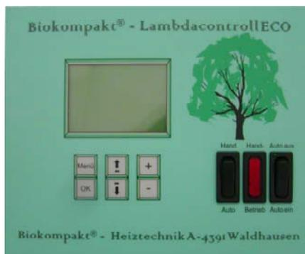
Die Lambdagesteuerte Pellet und Energiegetreideregung ist mit integrierter Leistungsregelung für den Leistungsbereich von 30% bis 100% ausgerüstet. Eine automatische Brennstoffabstimmung sorgt für eine saubere Verbrennung auch bei stark wechselnden Brennstoffarten. Die Temperaturgesteuerte Rücklaufanhebung ist zum Schutz des Heizkessels entwickelt, und zur Ansteuerung von einem 3-Weg-Mischer mit 230V Spannung geeignet.
