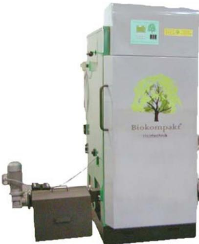
Die Prozessorgesteuerte Regelung errechnet, durch Einbeziehung der wichtigsten Komponenten (Rauchgastemperatur, Abgaswerte, Kesseltemperatur und Aufheizgeschwindigkeit) die Heizleistung des zugeführten Brennstoffes und verändert die Brennstoffzufuhr auf Grund der Leistungsabnahme.
