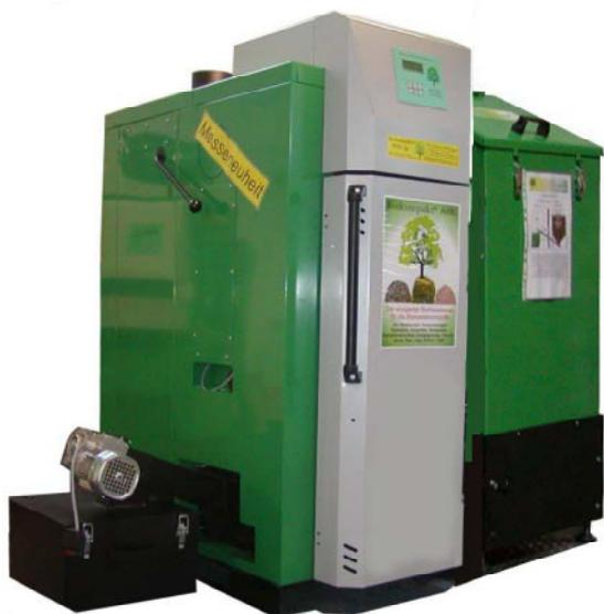
La ditta BIOKOMPAKT® Heiztechnik GmbH in A-4391 Waldhausen ha sviluppata una nuova caldaia con una nuova regolazione elettronica, idonea per la combustione di Pellet di legna, Pellet di paglia, Pellet di colza ed altra biomassa granulosa con grandezza <math>< \varnothing 10 \text{ mm}</math> e lunghezza mass. di 25 mm. Idonea anche per cereali energetici.
